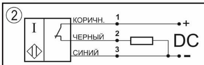
Схема соединения Нормально-замкнутый контакт
